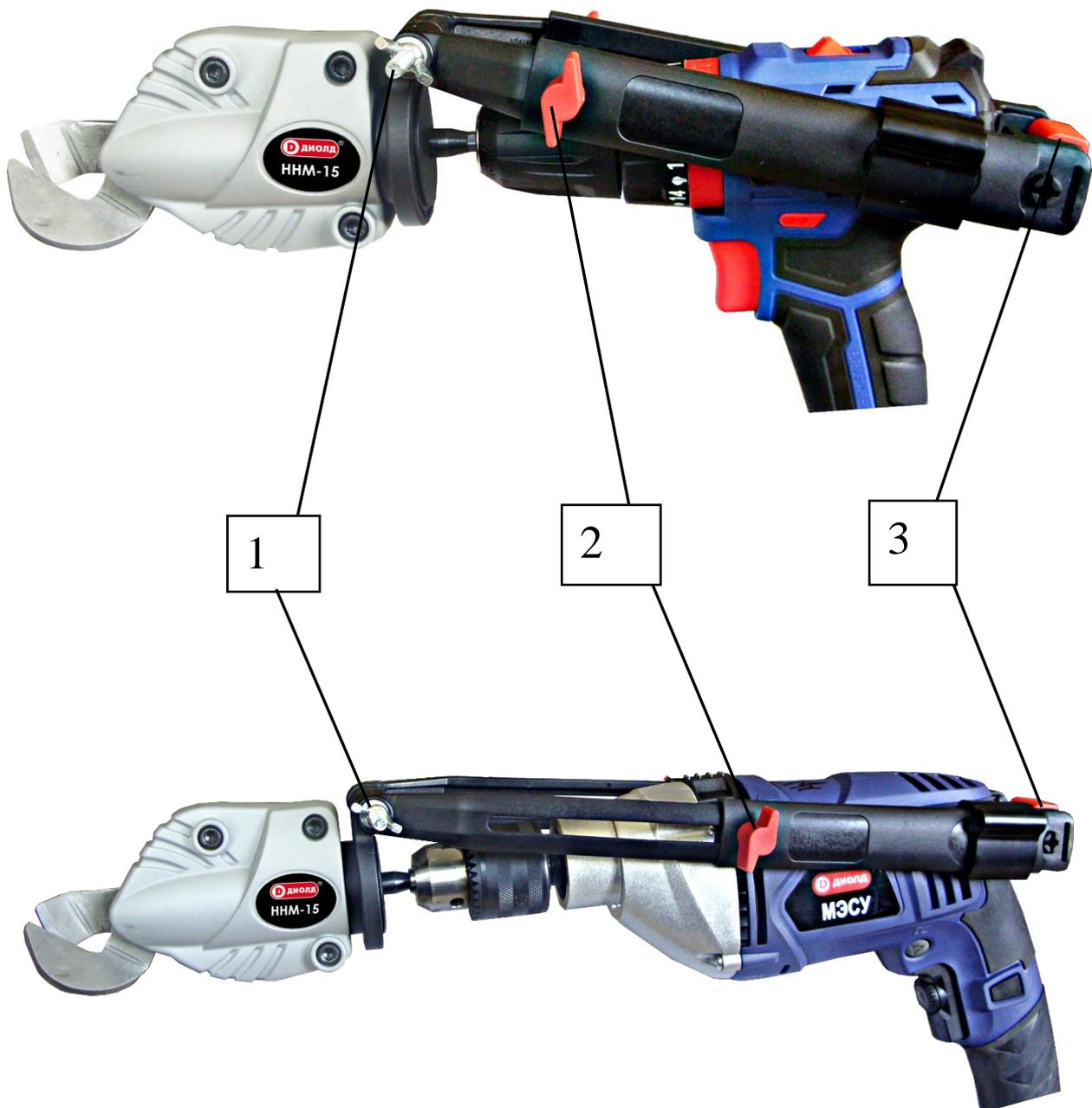
1 – комплект крепежа для регулировки угла наклона режущего инструмента относительно оси дрели / шуруповерта;
